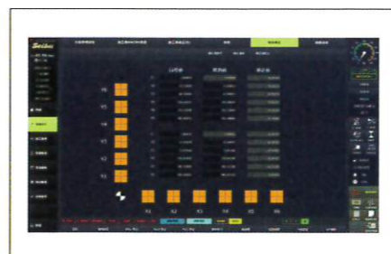
节距校正软件 校正 X 轴, Y 轴的直线度
