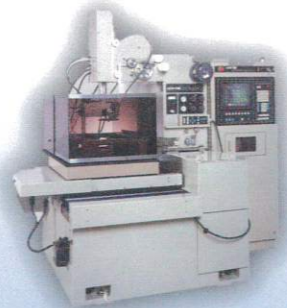
EW-450K 开发了铜线自动供给装置 退火方式AWF2B/在断 线点供给铜线
