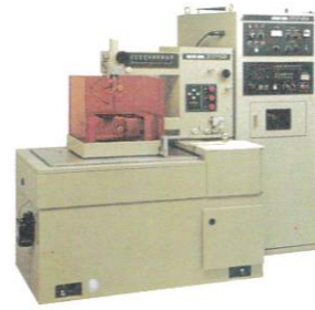
EW-25 采用了高速功率晶体管 可实现高速度加工
